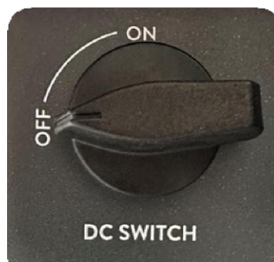
Slika 18: Izklop enosmernega toka izfotovoltaičnega sistema_1.1
