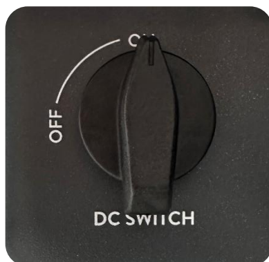
Abbildung 17: Deaktivierung der PV Gleichstromversorgung_1.1
